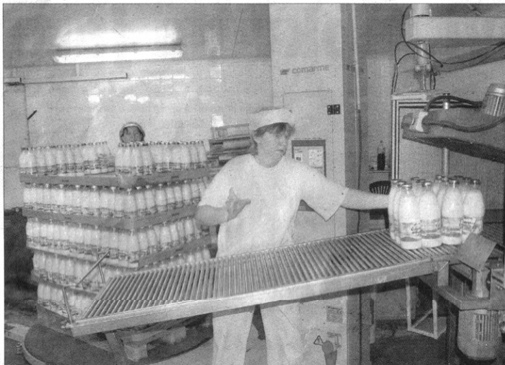
Díky nové technologii na balení mléčných výrobků do PET lahvi se zvýšila jejich trvanlivost
