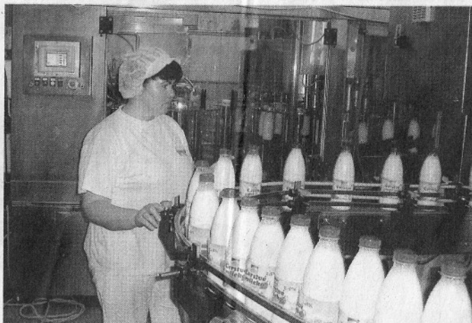
LINKA NA STÁČENÍ ČERSTVÉHO MLÉKA. Díky moderní technologii může frýdecko-místecká mlékárna dosáhnout u čerstvého mléka až patnáctidenní trvanlivosti. Foto: archiv
